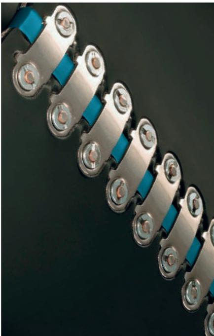
Le giunzioni Bolt solid plate sono progettate per soddisfare anche le esigenze di movimentazione dei materiali più complesse in quanto hanno una forte capacità di tenuta. Sono consigliate per nastri di spessori da 5mm a oltre 24mm.
